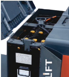
Yüksek Kapasiteli Akü High Capacity Battery
